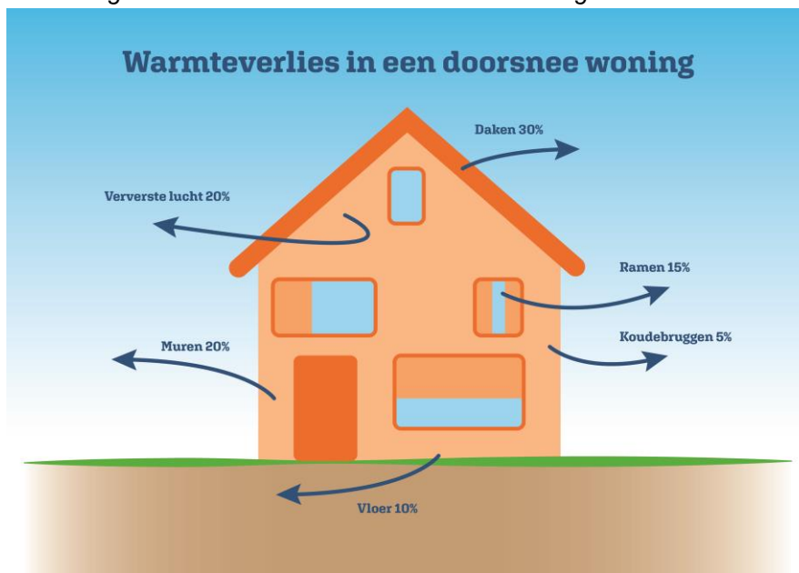
Afbeelding 6 – Warmteverlies in een doorsnee woning
